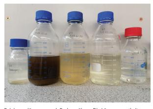
Reinigungslösungen nach Bodenspülung: Die Lösungen enthalten aus dem verunreinigten Boden herausgelöste PFAS.
