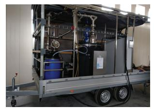
Mobile Versuchsanlage zur fraktionierten Eindampfung
