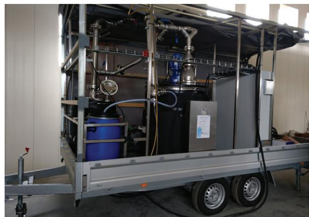
Mobile Versuchsanlage zur fraktionierten Eindampfung
